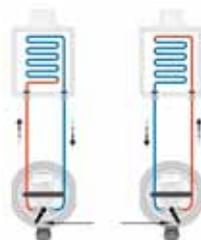
**Principe de l'inverseur de flux :** attaquer le bouchon ou les dépôts dans les 2 sens pour une action plus rapide et plus efficace.
