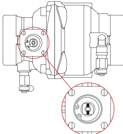
Premere il pulsante di sblocco e ruotare manualmente il perno motore in senso orario fino all'arresto
