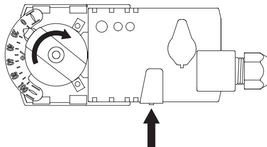
Inserire i perni (su lato inferiore dell'attuatore) nei corrispondenti fori sulla flangia superiore della valvola e premere fino al completo inserimento.
