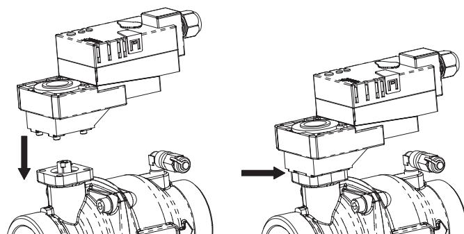
Montare la piastrina indicatrice 0-100% in dotazione, e, allineando la punta indicata al valore 0, inserire il perno centrale dell'attuatore fino al calzamento sullo stelo valvola. Fissare il perno centrale con la vite in dotazione
