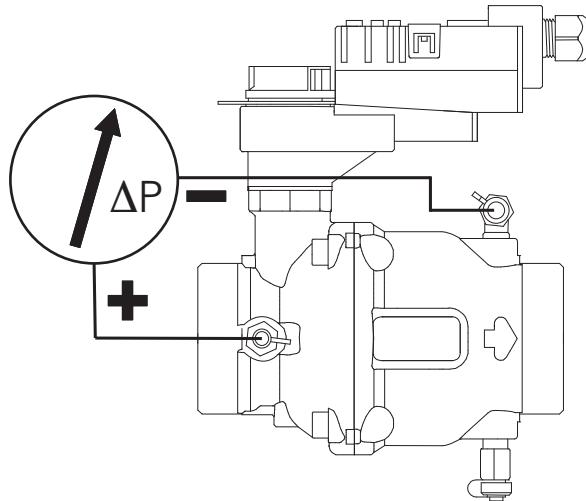
Connettere un manometro differenziale alle prese di pressione come indicato in figura e misurare la differenza di pressione ΔP<sub>1-2</sub>. Calcolare la portata tramite la formula:
