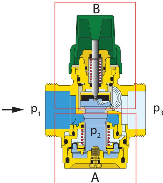
a) Le dispositif **(A)** contrôle et maintient constant la  $\Delta p_i$  ( $p_2 - p_3$ ), aux bornes du dispositif **(B)**, avec une action automatique (équilibre entre la force générée par le différentiel de pression et le ressort de rappel interne). Si  $(p_1 - p_3)$  augmente, le régulateur de  $\Delta p$  interne ferme le passage et maintient  $(p_2 - p_3) = \text{constant}$  ; dans ces conditions, le débit reste constant.
