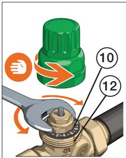
La rotation de la bague (10) détermine le numéro correspondant à la « Position de réglage » et provoque l'ouverture/fermeture de la section de passage de l'obturateur externe (13). Par conséquent, chaque section de passage réglée sur la bague correspond à une valeur donnée de  $Q_{max_x}$ .
