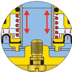
b) Le dispositif **(B)** contrôle le débit  $Q$ , en modifiant sa section de passage. La variation de la section détermine la valeur de la caractéristique hydraulique ( $K_v$ ) du dispositif de contrôle **(B)**, qui reste constant sur :
