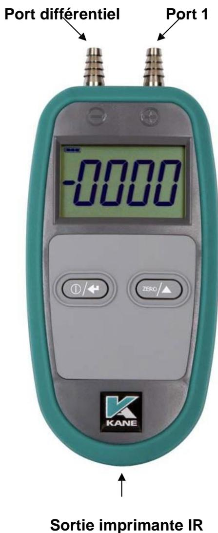
Toujours utiliser le port situé en haut à droite (en Port 1) pour prendre des mesures à un seul canal (pression ou vide). N'utilisez que le port de gauche pour les mesures différentielles.
