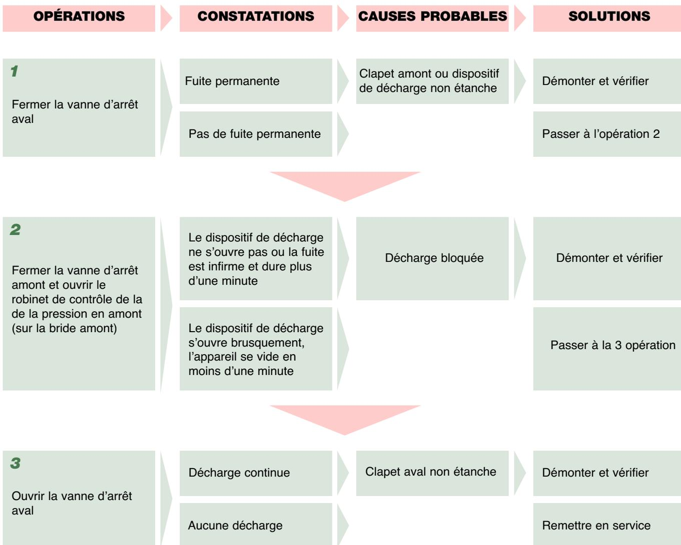
N.B. : Pendant le service normal, l'appareil ne doit présenter aucune fuite permanente. En cas contraire, démonter et vérifier.
