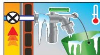
La pose d'un robinet d'isolement situé dans une zone hors gel est obligatoire.
