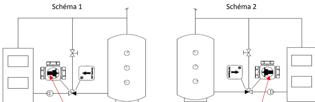
**Le bulbe de la cartouche thermostatique doit toujours être du côté de la chaudière**
