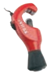
ZR 35 Ø 3 - 35 mm Épaisseur maxi : 3,2 mm. Ébavureur rotatif rétractable à lame interchangeable.
