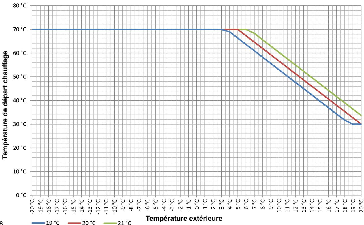
Les trois courbes à 19°C - 20°C - 21°C, représentent l'évolution de la température de départ chauffage en fonction de la consigne de température ambiante désirée.
