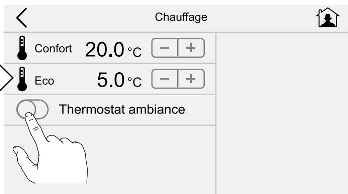
Habiller le thermostat d'ambiance uniquement dans le cas où une sonde d'ambiance est réellement connectée à la chaudière (le pont d'origine “TA” doit être dans ce cas retiré sur le bornier = “gateway”). L’Ufly BOX est alors utilisé comme un programmeur horaire.
