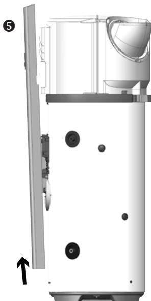
❺ Soulever la colonne pour la décrocher des inserts en bas en faisant attention au câble de commande et au câble de terre.
