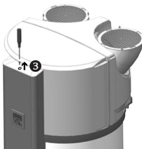
❸ Retirer la vis de verrouillage de la colonne.
