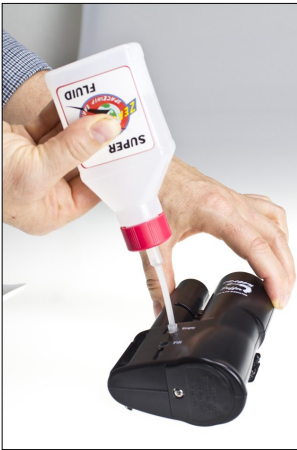
Abb. 7: Absaugen des Fluids aus dem Überlaufreservoir
