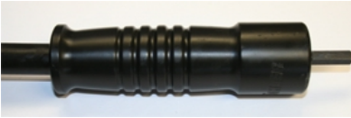
Abb. 4: Griff und Bohrzapfen
