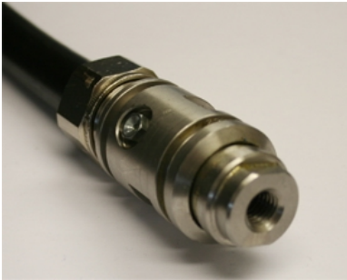
Image 5: Extrémité pour fixer les chaînes et graisseur
